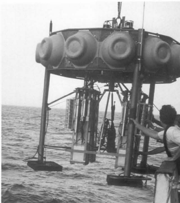
Abb. 12. Der Bio-C-Flux Lander wird von Bord des Forschungsschiffs METEOR ausgesetzt.
