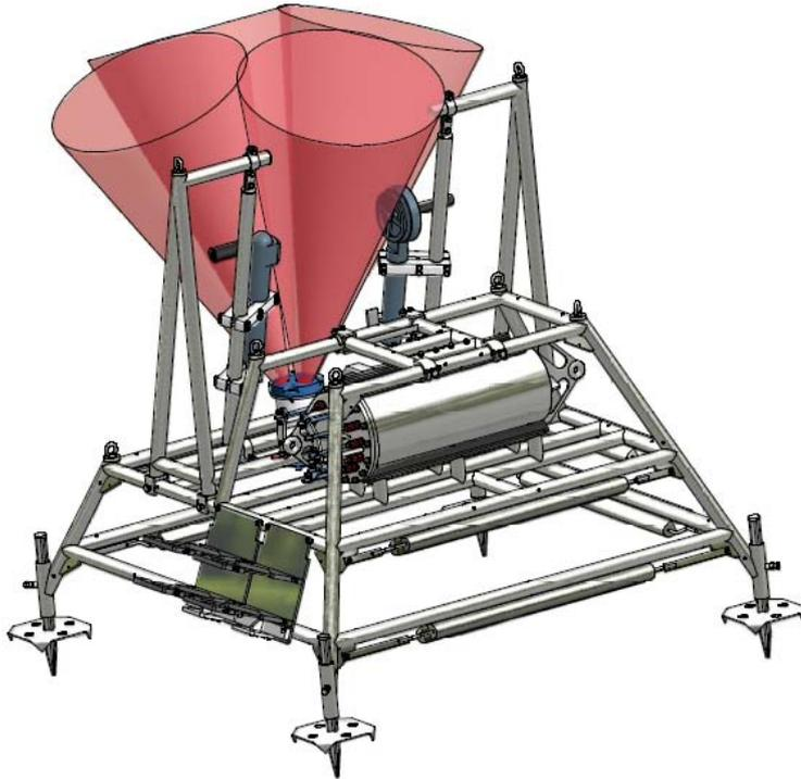
Abbildung 21: Das Zooplanktonobservatorium (Kombination aus ADCP und VPR) ist direkt auf einem Unterwasserknoten montiert, welcher von den Firmen 4H-Jena und loth-engineering gebaut worden ist. Die zugrunde liegende Unterwasserknoten-Technologie wurde im Rahmen von COSYNA vom HZG und dem AWI in enger Zusammenarbeit mit den beiden Firmen 4H-Jena (Jena, Deutschland) und loth-engineering (Wiesbaden, Deutschland) entwickelt.
