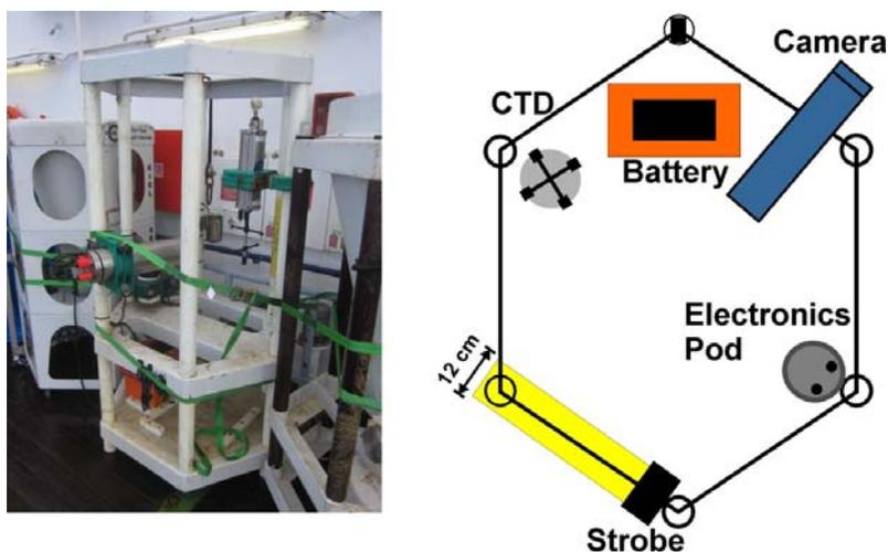
Abbildung 13: PVS Plattform an Deck von FS Poseidon und schematischer Aufbau des Systems.
