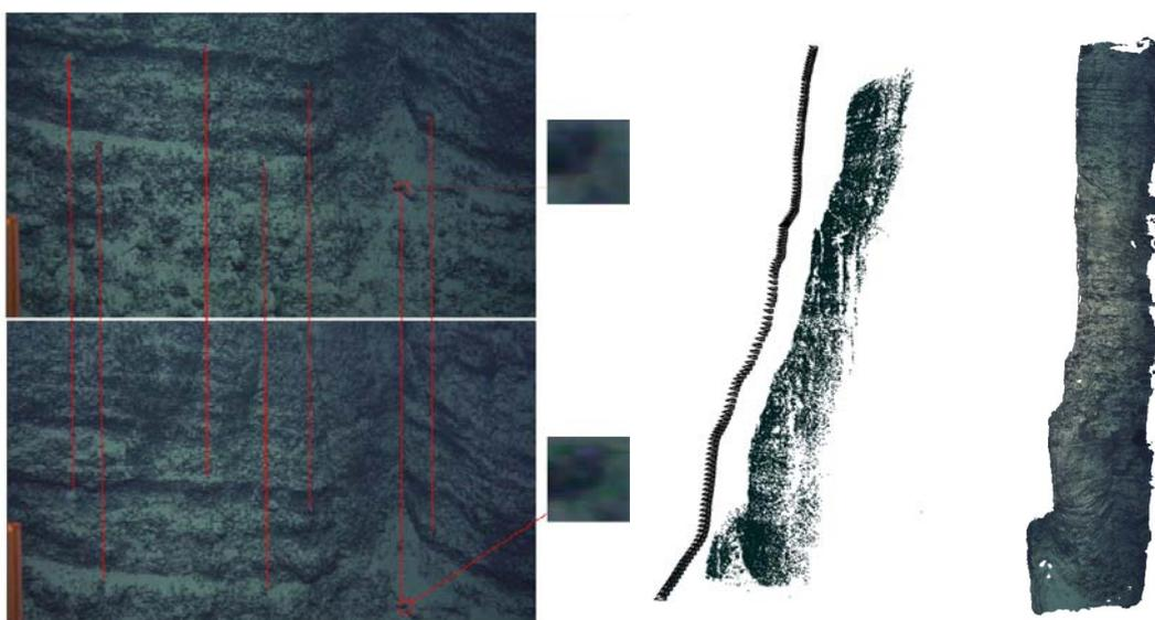
Abbildung 12: 3D-Rekonstruktion am Beispiel einer steilen Unterwasservulkanwand in 3500m Tiefe in der Nähe der Kapverdischen Inseln, siehe auch KWASNITSCHKA (2013). Linkes Bild: Beispielkorrespondenzen (rote Linien) aus zwei Videoframes mit Ausschnittvergrößerung eines automatisch verfolgten markanten Merkmales. Jeder Videoframe zeigt nur einen kleinen Ausschnitt des Vulkans, da während des Tauchvorgangs
