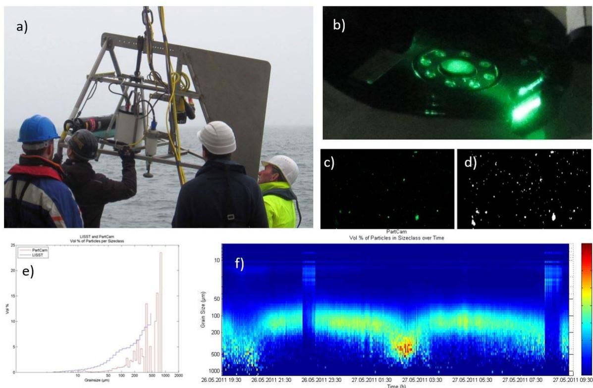
Abbildung 11: MARUM Partikelkamera "PCAM II" (G. Herbst & C. Winter) a) Einsatz in Tidengewässern im Messrahmen: PCAM II mit Sequoia LISST100X, ECM-CTD an Bord FS Heincke; b) Messvolumen im Laserfeld, c) Originalbild Partikel, d) optimiertes Binärbild Partikel, e) berechnete Partikelgrößenverteilung durch Bildanalyseverfahren, f) Zeitreihe der berechneten Partikelverteilung für einen Tidezyklus.
