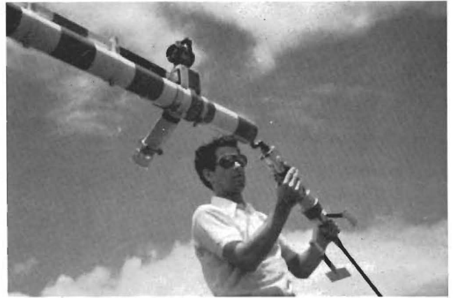
Abb. 8.16 Wartungsarbeiten an der Gust-Probe der NOAA DC-6.
