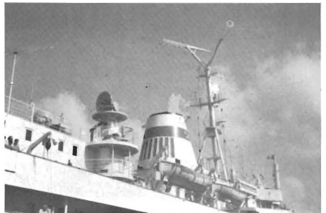
Abb. 8.6 Typischer Aufbau der UdSSR-Schiffe. Das Radargerät diente vor allem zur Windmessung.
