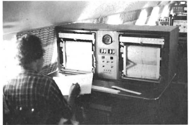
Abb. 8.14 Registrierung von Strahlungsflußdichten in der IL-18 des MGO (Leningrad).
