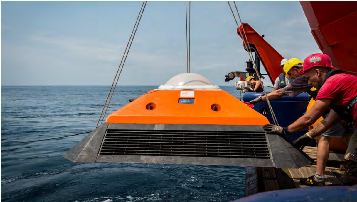
**Fig. 2:** Implantações de um escudo inferior com um medidor de corrente acústica (75kHz Longranger ADCP). A forma do escudo destina-se a evitar danos causados pelas actividades de pesca. Desta vez, adicionamos uma linha inferior de 1 km que pode ajudar durante a recuperação em caso de danos na libertação dentro do escudo (Foto: SVN).
