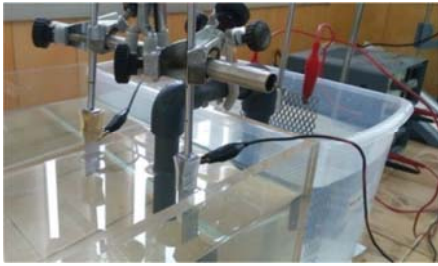
Fig. 1. Tanque utilizado en la electrolisis de agua de mar
