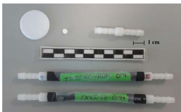
Fig. 1. Cartuchos \mu -SPE desarrollados y su acoplamiento a la bomba peristáltica.
