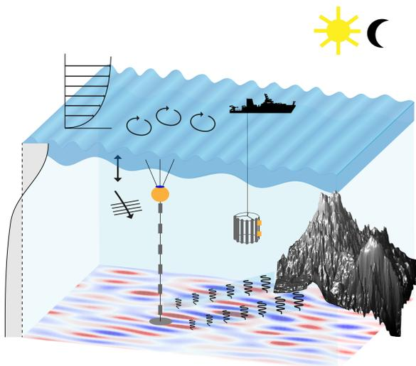
Schematische Darstellung der Gezeitenwellen südlich der Azoren (rot/blau), der Austauschprozesse, und unserer Messgeräte CTD/LADCP Sonde (am Schiff) und einer verankerten Messkette zur Beobachtung von zeitlichen Schwankungen.
