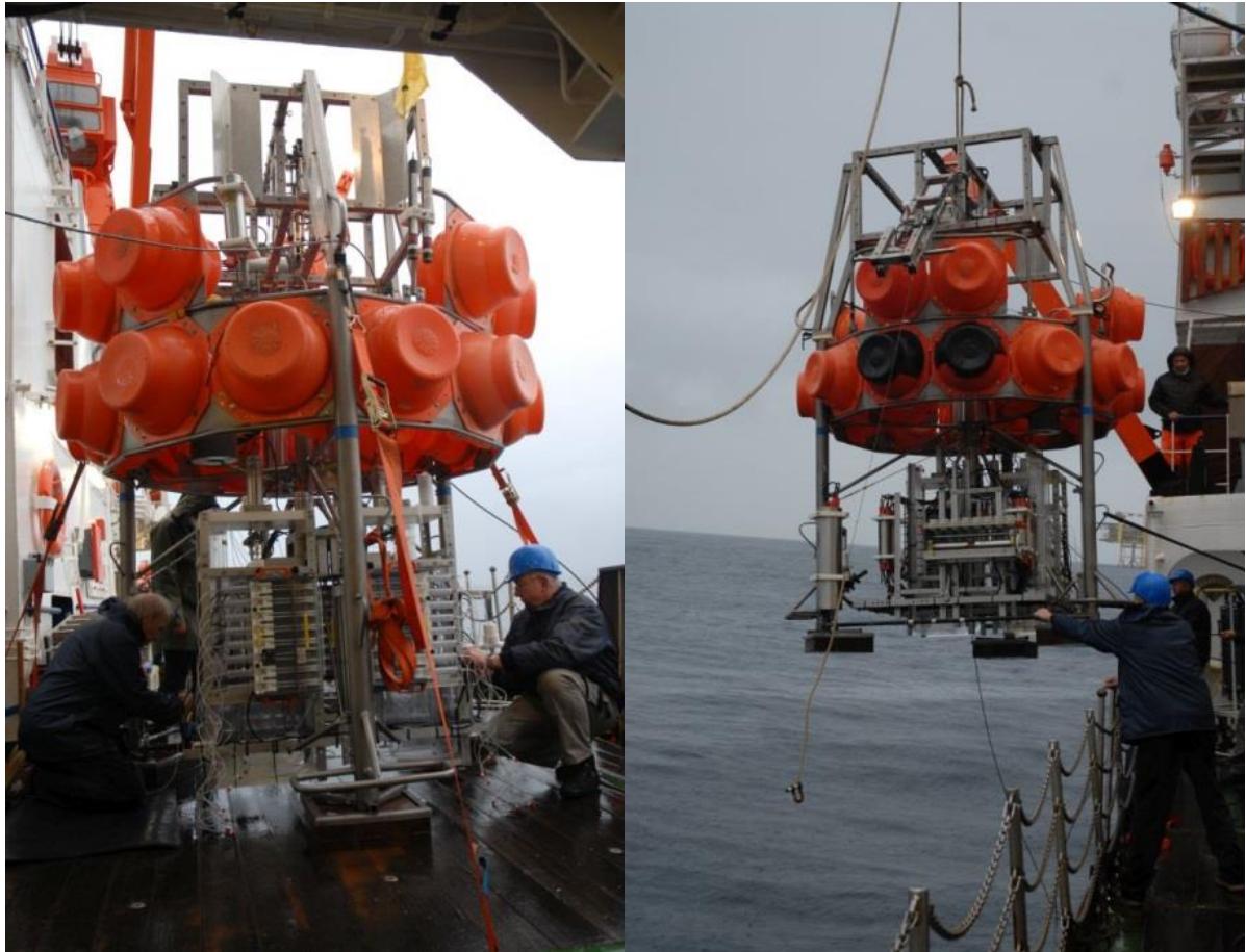
Vorbereitungen des BIGO Landers zum Einsatz. Aussetzen des BIGO-Landers mit Launcher. (alle Bilder P. Linke, GEOMAR)
