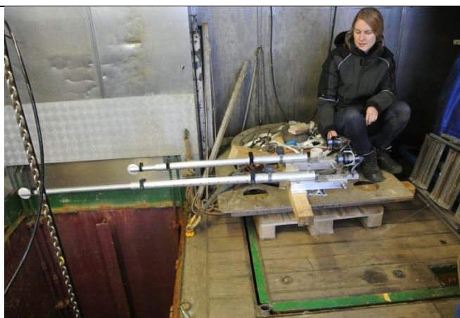
Abbildung 2: Teil des Aufbaus während der Kalibrierung des EK80. Eine Kalibrationskugel wird durch den Lotschacht (links zu sehen) mit Hilfe von Angelschnüren kontrolliert auf eine Tiefe von 8-10 m unterhalb des Schwingers positioniert (im Foto zu sehen: Mareike Kampmeier). [Foto: Line Hähnel]
