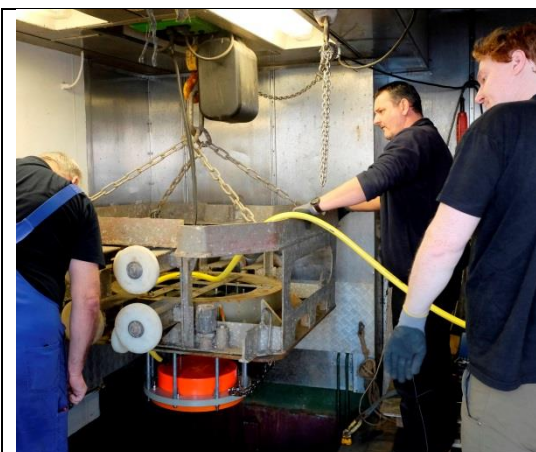
Abbildung 1: Einbau des 38 kHz Schwingers (orange farbiges Gerät) im Lotschacht (von links nach rechts: Peter Neumann, Olaf Willms, Florian Gausepohl). [Foto: Peter Urban]
