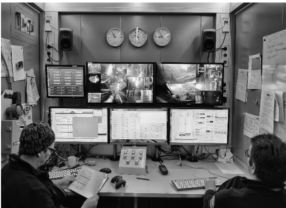
Abbildung 1: Vom Kontroll-Container aus wird das MeBo200 von 2 Operateuren eingesetzt. Mit Hilfe der Daten- und Videoübertragung vom Bohrergerät steuern Werner Schmidt und Adrian Stachowski den Bohrvorgang am Meeresgrund (© M. Beims).
