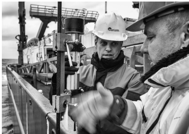
Abbildung 4: Um eine präzise Unterwassernavigation bei der Platzierung aller Geräte auf dem Meeresboden durchzuführen, nutzen wir das bordeigene Posidonia-System. Thomas Pape bringt mit Schiffsmechaniker Henry Schabeck den Posidonia Transponder dazu am Schiffsdraht über dem Schwerelos an.
