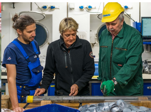
Abbildung 2: Im Geolabor wird der 3,8 m lange Sedimentkern in einzelne Segmente unterteilt und beschriftet, bevor er längsseits aufgeschnitten und in Archiv- und Arbeitshälfte unterteilt wird (© C. Rohleder).
