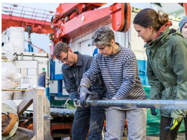
Abbildung 1: MeBo200 Sedimentkern, der gerade von den Wissenschaftlern aus dem Kernrohr gezogen wurde und zur weiteren Bearbeitung ins Labor getragen wird (© C. Rohleder).
