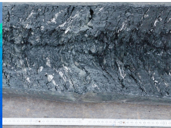
Abbildung 5: Kernabschnitt des Schwerelotes GeoB22606 zeigt die eiszeitlichen Seeablagerung, die durch Eisenreduktion und Ausfällung von Eisenmonosulfiden dunkel bis schwarz gefärbt sind. Weiße Gashydratlagen sind schichtparallel eingeschaltet.
