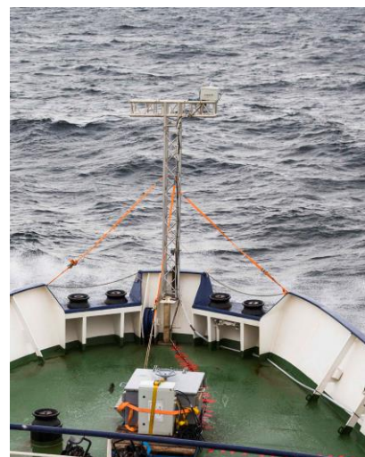
Bug der Poseidon mit dem Messmast für die Eddy-Kovarianz-Messungen. (Foto: Lisa Hoffmann)
