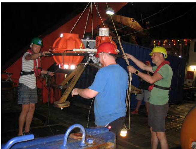
Abb. 1: Auslegung eines Bodendruckensors vor der Küste Brasiliens (Foto: Martina Nielsen).
