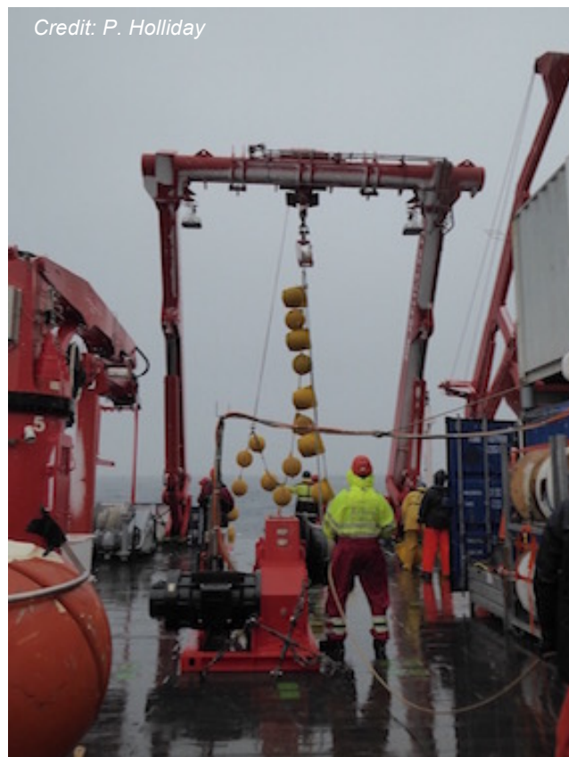
Aufnahme einer Verankerung über den A-Rahmen bei leichtem Schneetreiben in der zentralen Labrador See.
