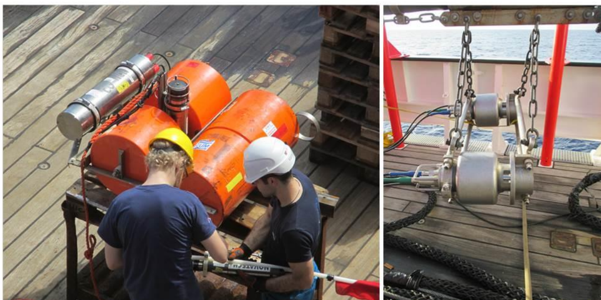
Rechts: Eine der 50 OBS Stationen wird für den Einsatz vorbereitet. Links: Zwei der 6 Luftpulser des Backbord-Clusters. Zusammen mit dem Cluster steuerbords haben die Luftpulser ein Gesamtvolumen von 84 Litern Druckluft.
