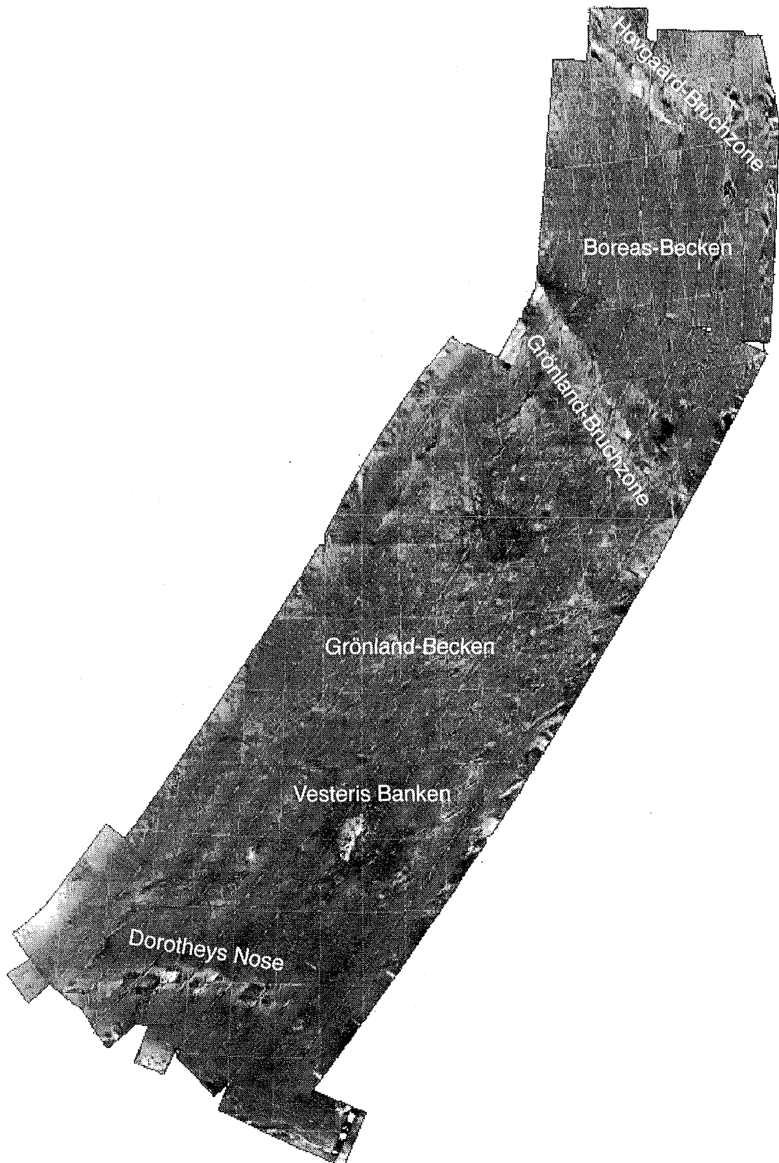
Abbildung 45: GLORIA-Aufzeichnungen zeigen das gesamte Arbeitsgebiet, wobei die Daten um den Faktor 6 und damit auch die Auflösung reduziert wurden. Dargestellt ist das Rückstreuungsvermögen des Meeresbodens.
