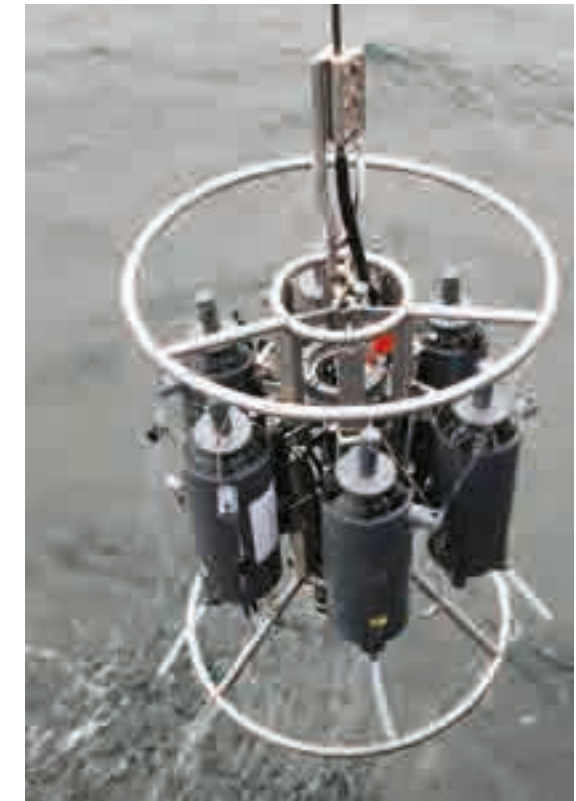
3.6 > Seit 1957 untersuchen Forscher regelmäßig das Wasser an einem bestimmten Punkt der Eckernförder Bucht an der Ostseeküste. Heute werden dazu moderne Wasserschöpfer verwendet, die in verschiedenen Tiefen Wasserproben nehmen.
