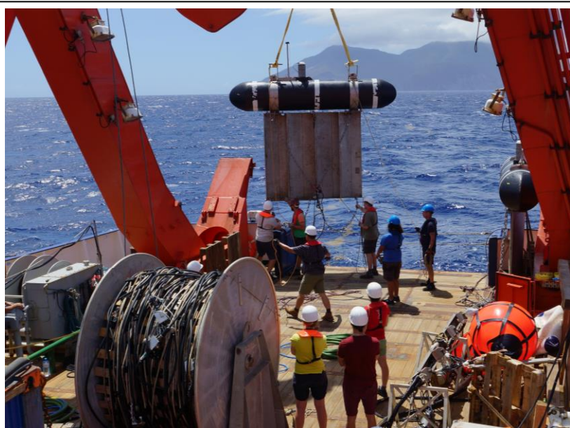
Abb. 1: Aussetzen des Steuerbord Scherbretts. Photo: Stefan Kontradowitz.
