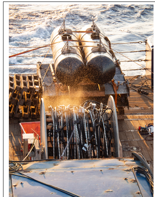
Abb. 1: Abgebaute Scherbretter an Deck der Meteor. Photo: Insa Hollenberg.
