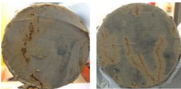
Abbildung 37: Horizontale Schnittflächen durch eine Sedimentprobe aus dem Schwarzen Meer zeigen die heterogenen Strukturen natürlicher Proben. Bräunlich verfärbte Bereiche zeigen vorhandene Störzonen bzw. Risse, die als Aufstiegswege für Gas gewirkt haben können.
