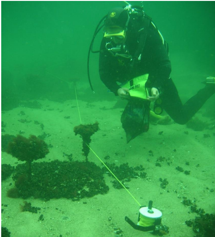
Abbildung 1: Taucher bearbeiten eine Betongrundplatte mit von einer Miesmuschelgemeinschaft bewachsenen Kunststoff-Besiedlungsplatten
