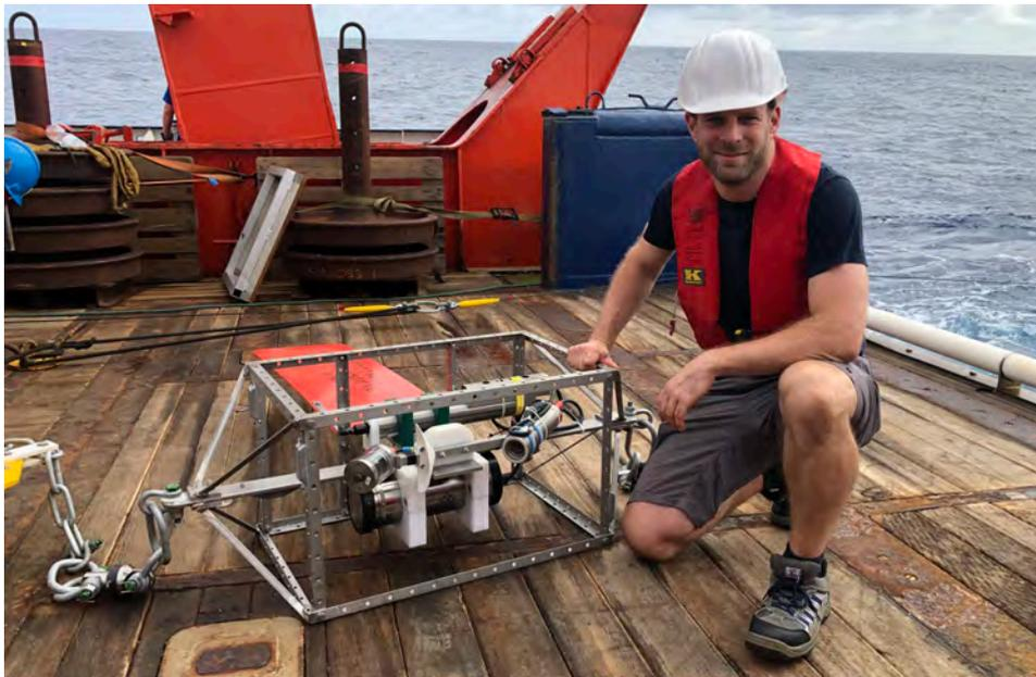
**Abb. 2:** Der *Underwater Vision Profiler* ist im Verankerungskäfig installiert und bereit zur Auslegung. Rainer Kiko, der diese Messtechnik während der letzten GEOMAR-Forschungsfahrten etabliert hat, wird im Dezember 2019 für fünf Jahre im Rahmen eines kürzlich eingeworbenen MOPGA (Make our Planet Great Again) Projekts ans Laboratoire d'Océanologie in Villefranche-sur-Mer (LOV), Frankreich, wechseln. Die UVP Auslegung ist eine Kooperation zwischen LOV und GEOMAR (Foto Iris Kriest).
