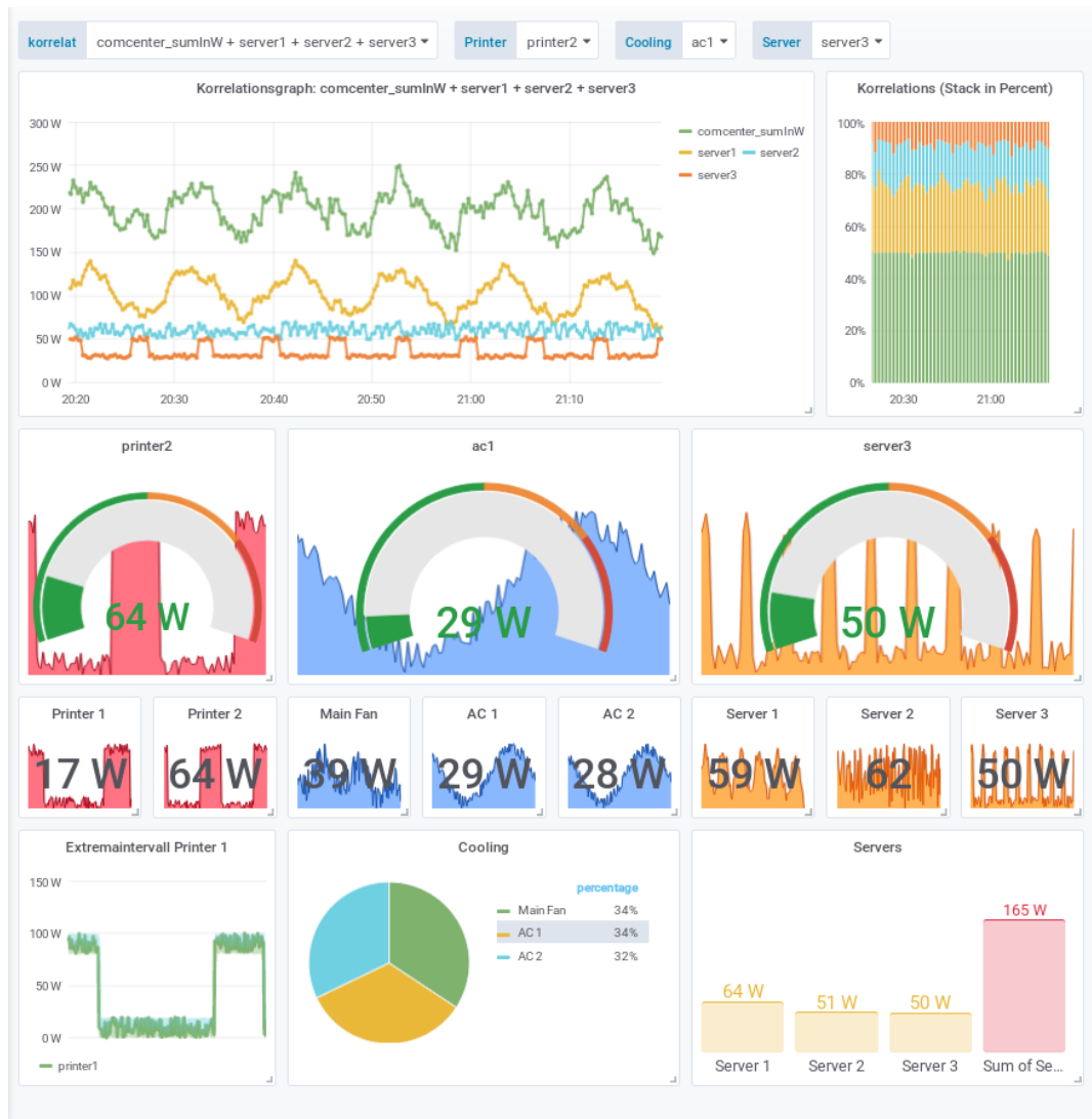
Abbildung 4.8. Detail- und Korrelationsoberfläche des Grafana Dashboards. Im oberen Bereich ist ein Graph, über den mithilfe von Variablen verschiedene Korrelationen aufgezeigt werden können. Rechts neben dem Graphen haben wir ein Balkendiagramm konfiguriert, welches dieselbe Variable benutzt wie der Graph. Das Balkendiagramm ist als Stack-Diagramm konfiguriert, welches den Anteil einer Metrik in Prozent visualisiert. Darunter haben wir Graphen, die einen auswählbaren Wert aus den Bereichen Printer, Server oder Cooling darstellen. Jeweils zugehörig zu den Gruppen sind Singlestat Panels vorhanden, die die Werte der physikalischen Sensoren illustrieren. Für jede Gruppe haben wir im unteren Bereich exemplarisch eine weitere Darstellung gewählt: das Extremaintervall für Printer1, ein Kreisdiagramm für das Cooling und ein Bar Gauge für die verschiedenen Server.
