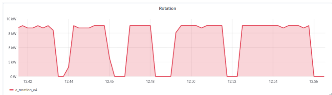
Abbildung 5.2. Visualisierung der Stromverbrauchsdaten einer Druckmaschine mit der Bezeichnung e_rotation_e4. Die Abbildung zeigt den Stromverbrauch gestaucht an.
