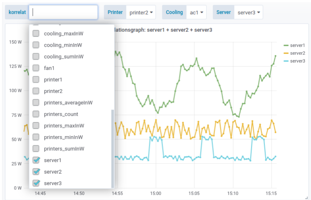
Abbildung 4.7. Menüband der Grafana Variablen. An dieser Stelle sind server1, server2 und server3 ausgewählt. Die Bezeichnungen der Zeitreihen entsprechen der eingeführten Namenskonvention.
