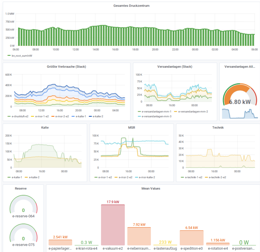
Abbildung 5.6. Dashboard Oberfläche mit Messwerten des Druckzentrums der Kieler Nachrichten. Das Dashboard zeigt in diesem Fall Messwerte des Zeitraums vom 01.08.2018 06:00:00 Uhr bis zum 02.08.2018 06:00:00 Uhr. Oben wird der Gesamtverbrauch abgebildet, darunter zeigen wir Graphen und Korrelationen verschiedener Verbraucher. Die Gauges im unteren Teil des Dashboards zeigen Verbraucher, deren Energieverbrauch vermeintlich weniger Relevanz besitzt.
