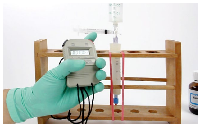
Abb. 4: Die Menge des erzeugten Produkts (Sauerstoff) wird 3 Minuten lang alle 10 Sekunden abgelesen.
