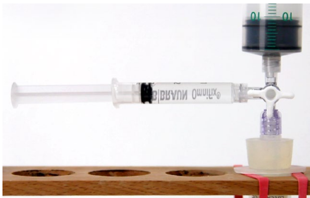
Abb. 1: Versuchsaufbau. Die Verbindung zwischen der Substrat- und Enzymspritze ist geöffnet.
