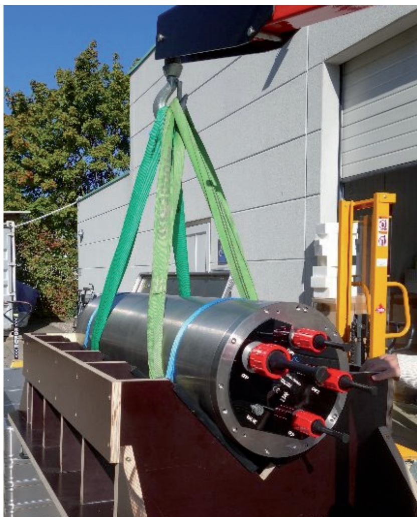
Abb. 1: Eine Batterie mit 190 V und 10 kWh, mit einer Ausgangsleistung von 10 kW und einem Titangehäuse für 6000 m
