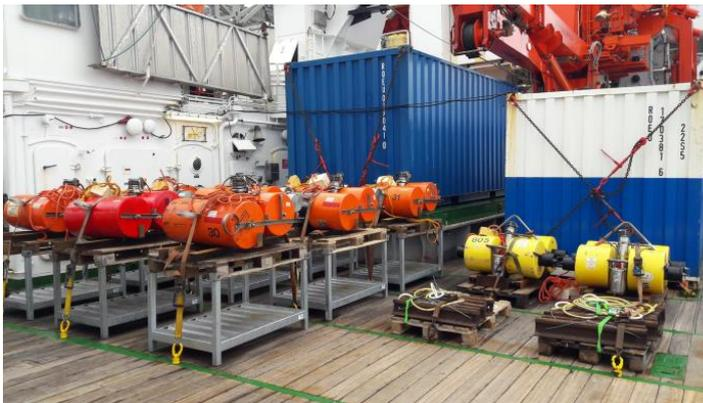
*Ozean-Boden-Seismometer des GEOMAR an Deck der METEOR*
