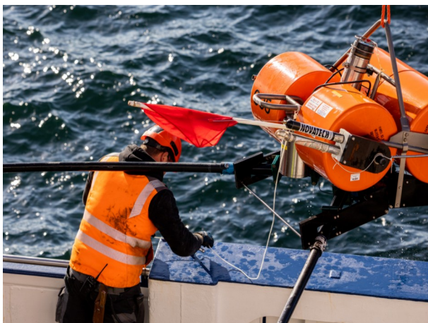
Abb. 2: Bergung des Ankers, der über eine lange Leine mit dem vorderen Ende der OBEM Station verbunden ist. (Foto: Thies Bartels)
