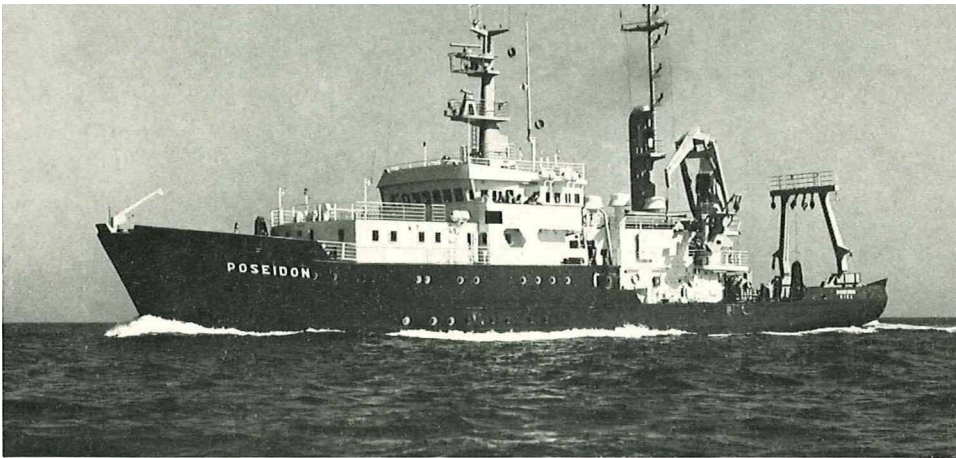
Abb. 1: Neues Forschungsschiff „POSEIDON“ (1059 BRT, 60,8 m Länge, 16 Mann Besatzung, 12 Plätze für Wissenschaftler)
