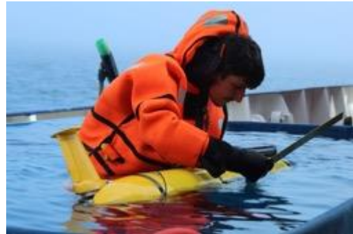
Félix Margirier (GeorgiaTech, USA) installiert einen Flügel am Unterwasser-Gleiter im Testbecken an Deck des FS METEOR. Foto: L. Blum
