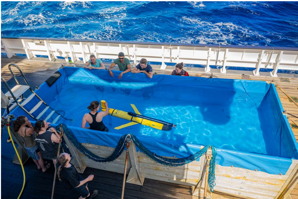
Abb. 4: Test des autonomen Gleiters im Pool an Bord des FS Sonne. Der Gleiter (gelb) ist mit mehreren hydrographischen Sensoren und einer Mikrostruktursonde (das schwarze Instrument auf dem Gleiter) ausgestattet (Foto: David Menzel).
