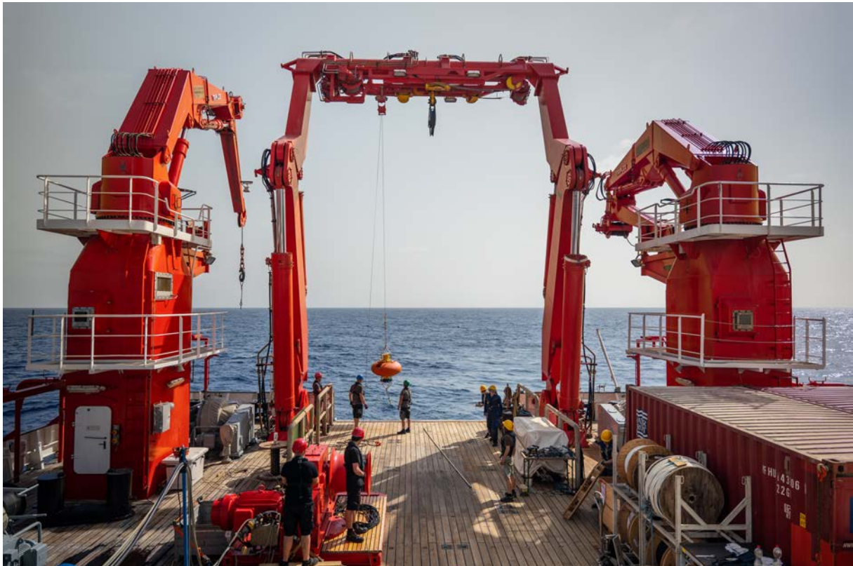
Abb. 1: Ausbringung der Cape Verde Ocean Observatory Verankerung. Das obere Element der Verankerung befindet sich bereits im Wasser. Hier wird gerade das ADCP (Acoustic Doppler Current Profiler) ausgebracht, welches sich zum Schluss 300 m unter der Oberfläche befindet (Foto: David Menzel).
