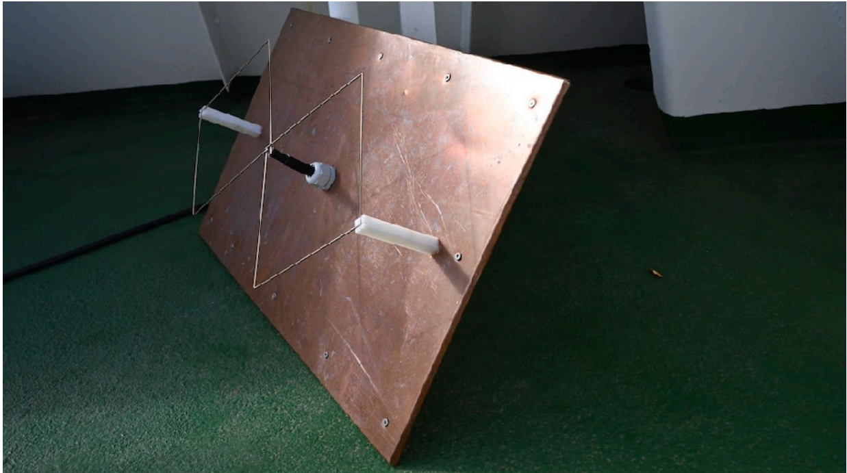
Abb. 2: An Bord gebaute Bi-Quad Antenne zur Verstärkung des gemessenen Radiosondensignals (© Julia Windmiller)
