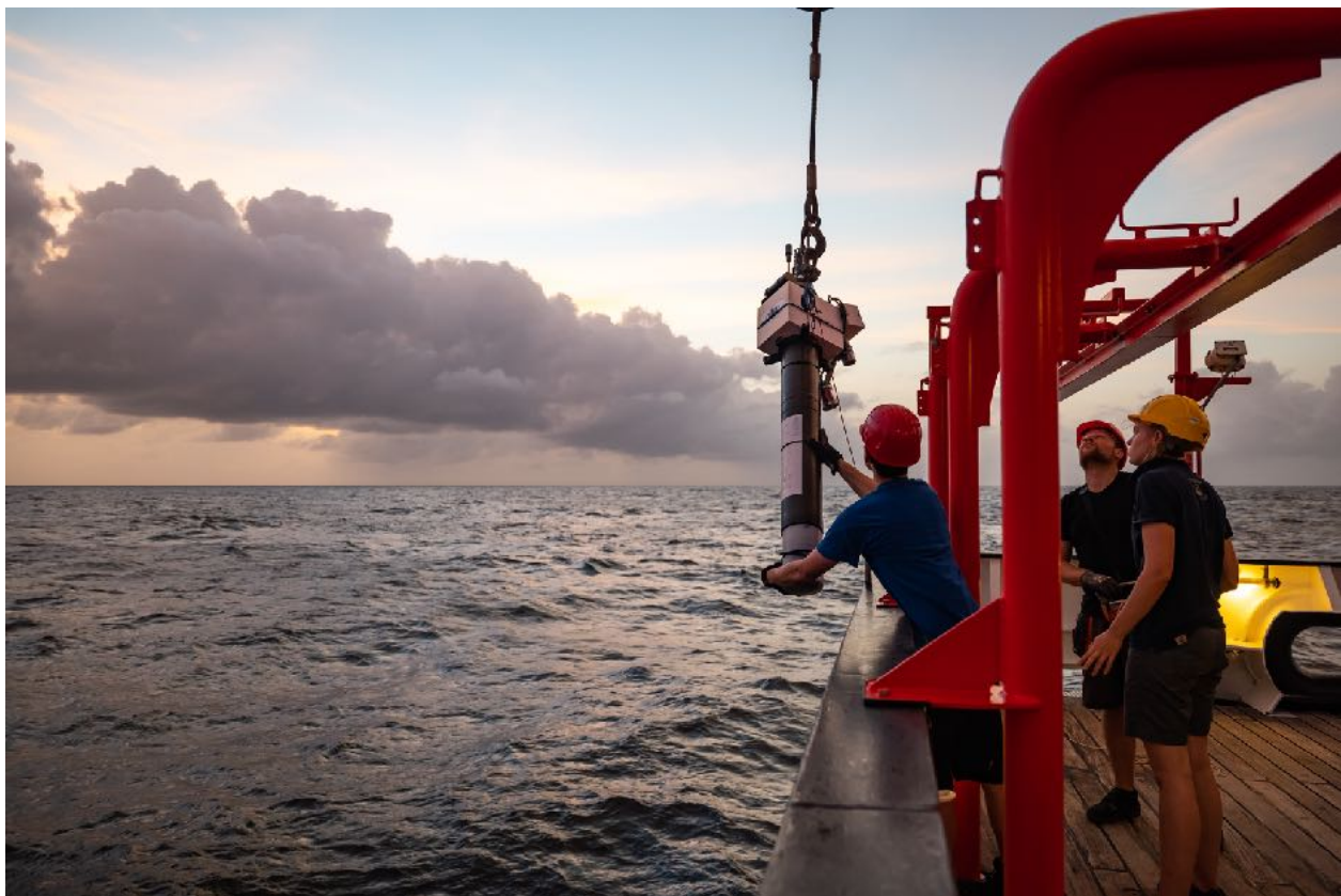
Abb. 4: Auslegung eines Argo-Tiefendrifters mit einer Underwater-Vision-Profiler. Mit diesen Messungen sollen Anzahl und Grösse von sinkenden Partikeln bestimmt und Aufnahmen von unterschiedlichen Planktonarten gewonnen werden (© David Menzel).
