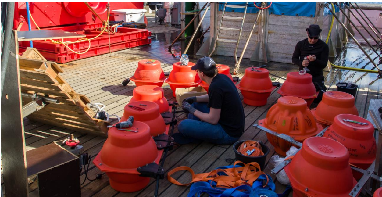
Auftriebsbälle werden für die bevorstehenden Verankerungen des TRR181-Programms vorbereitet und montiert (© Universität Hamburg/Knut Heinatz)
