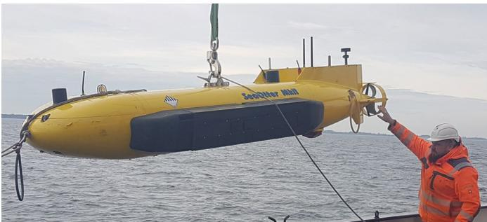
Abbildung 1: Aussetzen des AUVs ‚SeaOtter‘ der WTD-71. Das AUV ist mit einem SAS System ausgestattet und ermöglicht hochauflösende Sonarbilder des Meeresbodens. Je nach Frequenz, können auch Objekte im Sediment visualisiert werden.
