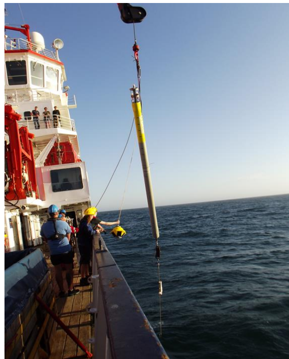
Abb. 1: Aussetzen eines Driftkörpers für die Erfassung der Variabilität von Strömungen und Hydrographie während des Mess-programms entlang von 23°S. (Bild: Martina Nielsen)
