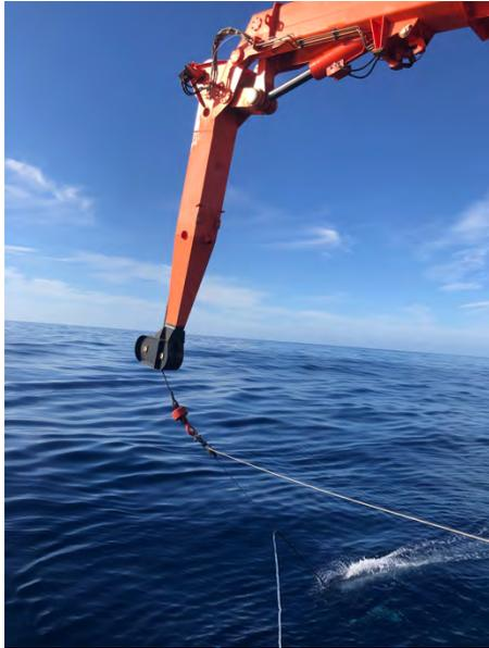
**Abbildung 2.** Der so genannte "Schleppfisch", mit dem Meerwasser in ein Labor auf der FS Meteor gepumpt wird. Dieses Wasser ist nicht mit Spurenelementen verunreinigt und kann für Experimente verwendet werden, um die Kontrolle des Phytoplanktonwachstums in dieser Region zu testen.
