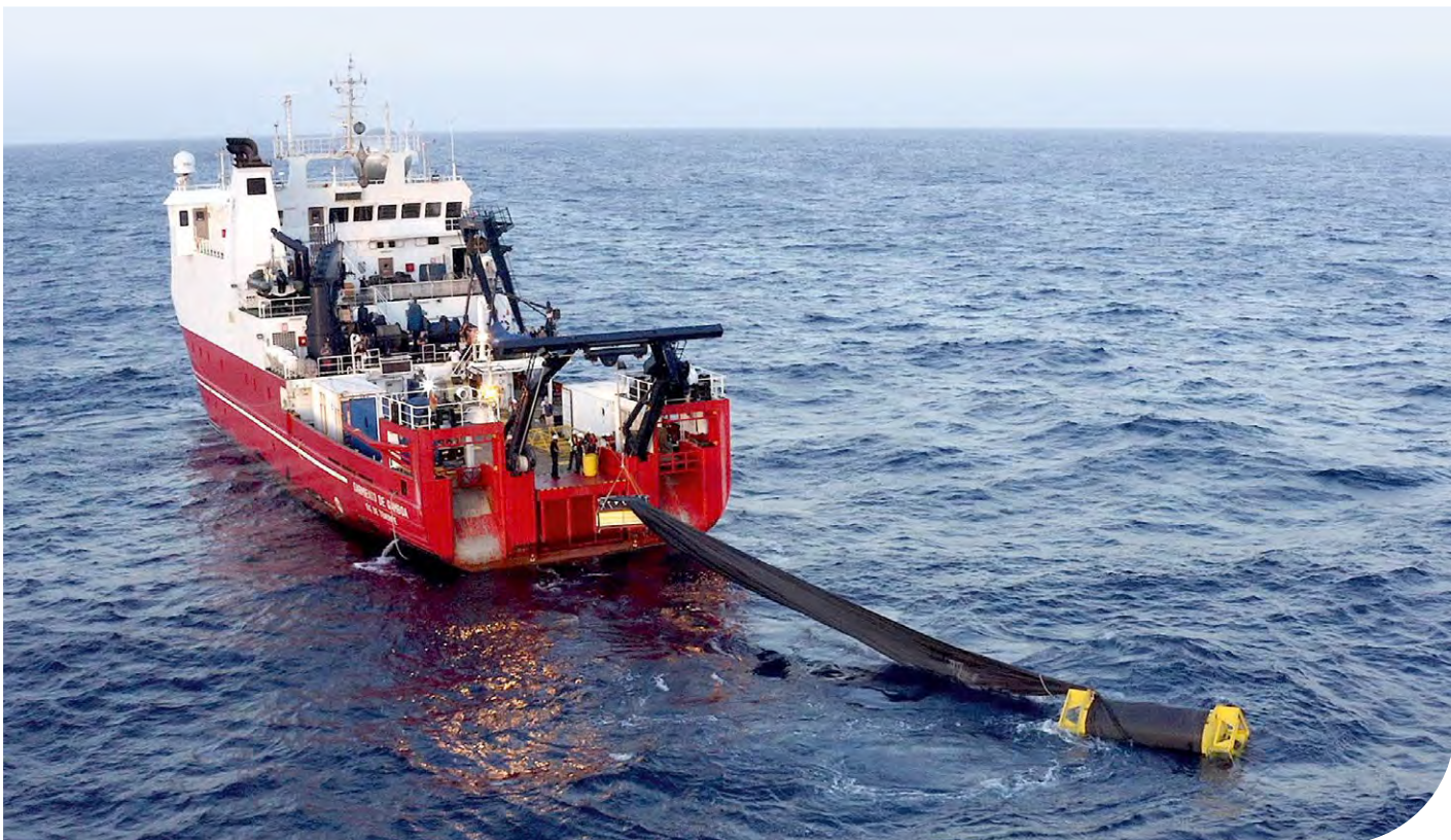
Ein spanisches Forschungsschiff setzt im November 2022 die Wellenpumpe der CDRmare-Forschungsmission für Testzwecke aus.
