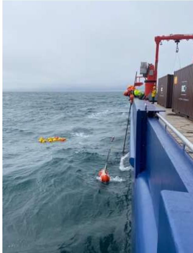
*Eine nach ablösen des Bodengewichtes an der Oberfläche treibende Verankerung wird an den Hacken genommen und dann in den folgenden Stunden an Deck der Maria S Merian gebracht (Abb.: Fehmi Dilmahamod)*
