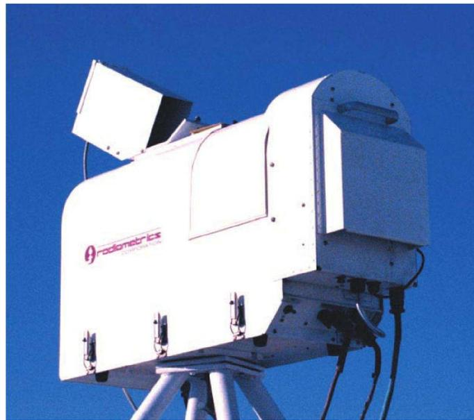
**Abbildung 4.2:** 12 Kanal Mikrowellenprofiler [Ware et al.(2003)]
