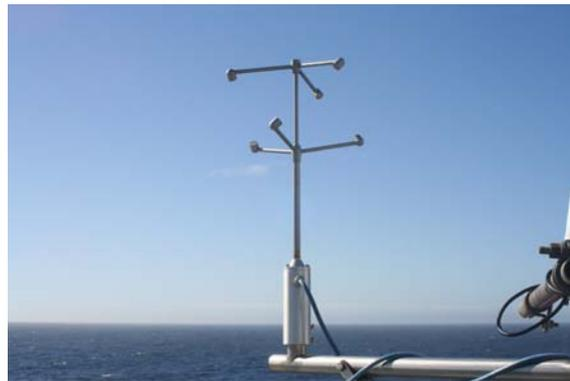
**Abb. 3.2:** *Ultraschallanemometer auf dem Peildeck während ANT XXV-5.*
