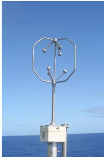
**Abb. 3.1:** *Ultraschallanemometer Sonic USA-1 auf dem Krähennest.*
